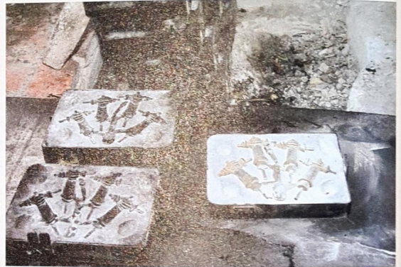
Nach dem Erstarren des flüssigen Messings wird die Form geöffnet und die Werkstücke werden entnommen. Dadurch wird die eigentliche Gussform zerstört (Prinzip der verlorenen Form).
