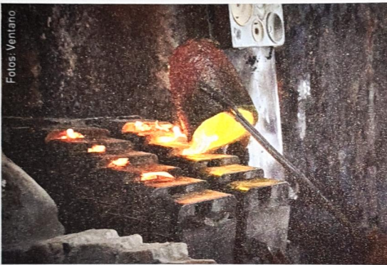
Das flüssige Messing wird in die vorbereitete Sandform gegossen. Als Ausgangsmaterial kommt hierbei auch recyceltes Messing zum Einsatz.
